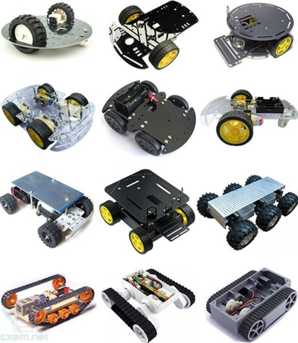
При выборе шасси обращайте внимание на питание и мощность двигателей, а также на обороты моторчиков и наличие редуктора. Хотя большинство платформ содержат стандартный 6В моторчик с редуктором.
