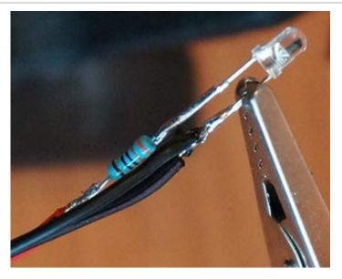
К модулю Bluetooth подключаем или подпаиваем все необходимые провода, помимо светодиода это питание, GND, ТХ и RX. Смотрите документацию на ваш Bluetooth модуль. Чтобы не мучаться с пайкой, я вам советую сразу взять модуль с подпаянными штыревыми выводами (см. фото выше). И лучше брать модули HC-03/HC-05.
