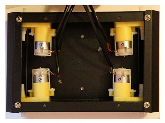
На верхнем фото хорошо видно, что левые и правые двигатели относительно друг-друга расположены несоосно из-за непродуманности китайской конструкции, и из-за этого колеса немного проскальзывали при движении. Поэтому потребовалось небольшая доработка, для этого я вырезал распорки из пластика и вставил их между двигателями.
