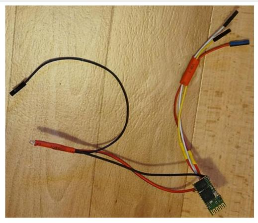
Его я также разместил в термоусадочной трубке большого диаметра.
