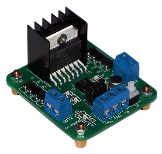
Подключение к Arduino достаточно подробно описано в <u>этой статье</u>. В нашем проекте для плавного изменения скорости вращения двигателей, мы будем использовать ШИМ (широтно-импульсную модуляцию).
