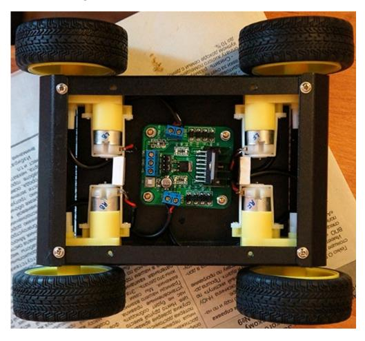
Провода от 4-х моторов подключаем к плате драйвера двигателей L298N, левые 2 мотора просто запаралеленны, тоже самое и правые.
